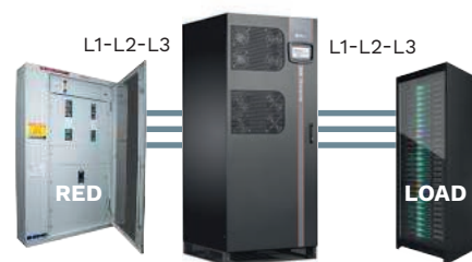
instalación de 3 conductores (L1-L2-L3)
