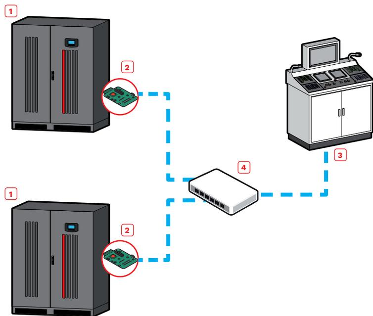
Pour la gestion des ASI dans les environnements industriels ou civils nécessitant une communication par protocole Modbus sur Ethernet.
