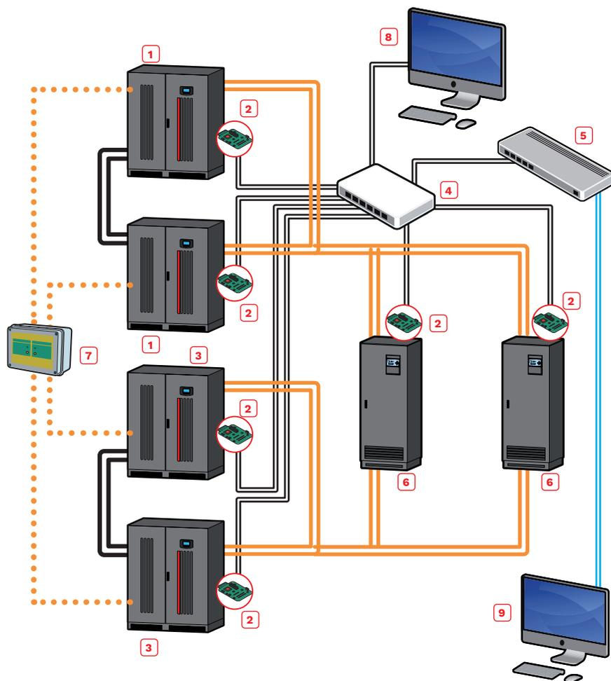
La version COMPLÈTE du logiciel PowerShield<sup>3</sup> doit être utilisée pour gérer des configurations avec plusieurs ASI installées en parallèle et chaque ASI doit avoir une carte NetMan 208 installée.
