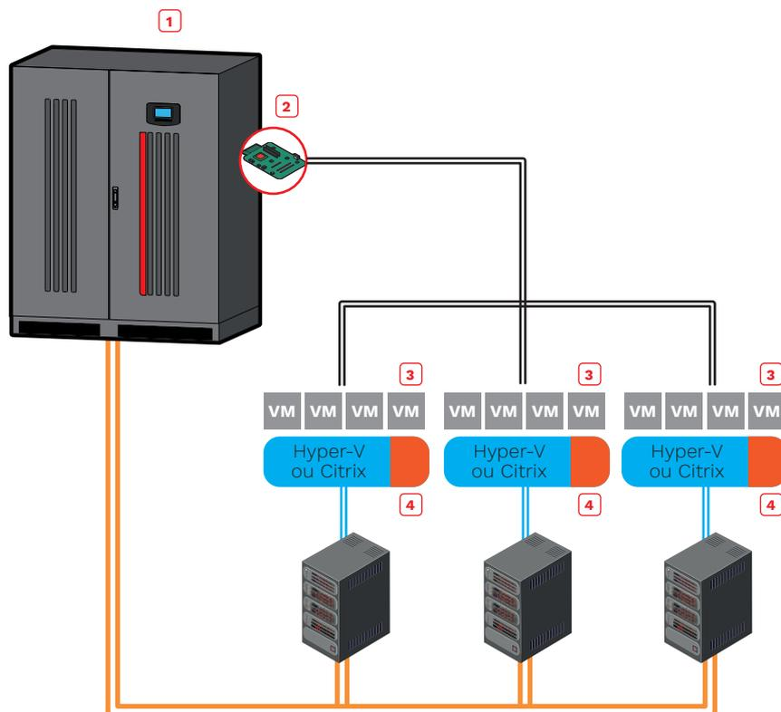
Le logiciel PowerShield<sup>3</sup> doit être utilisé pour gérer la configuration avec l'ASI, un script spécifique pour arrêter le système de virtualisation doit être utilisé, l'ASI doit avoir une carte NetMan 208 installée.
