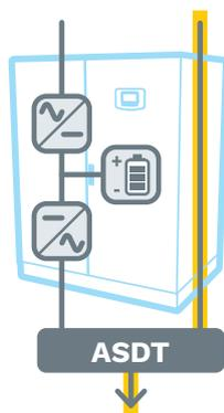
En cas de panne de l'alimentation électrique, le dispositif automatique interne (ATSD) transfère la charge à l'onduleur. La batterie fournit l'énergie à l'onduleur, assurant ainsi la durée de fonctionnement nécessaire.
