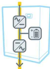
En cas de panne d'alimentation, la batterie fournit l'énergie à l'onduleur, assurant ainsi la durée de fonctionnement requise sans aucune interruption.
