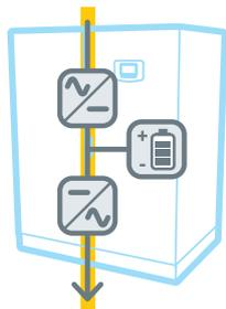
In caso di guasto dell'alimentazione, la batteria fornisce energia all'inverter assicurando l'autonomia richiesta senza alcuna interruzione.
