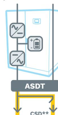
A differenza di quanto descritto al punto C, parte del carico viene alimentata senza interruzione, mentre la parte rimanente del carico viene alimentata solo alla mancanza rete grazie al dispositivo CSD (uscita sempre alimentata + solo emergenza "SA+SE").
