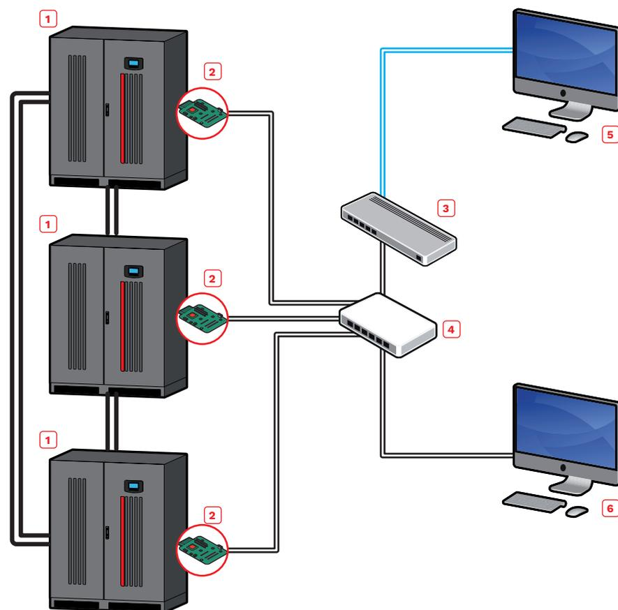
Per la gestione di configurazioni con diversi UPS in parallelo deve essere utilizzata la versione FULL del software PowerShield<sup>3</sup> e in ogni UPS deve essere installata una scheda NetMan 208.
