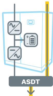
In caso di guasto dell'alimentazione, il dispositivo automatico interno (ATSD) trasferisce il carico all'inverter. La batteria fornisce energia all'inverter, assicurando l'autonomia richiesta.
