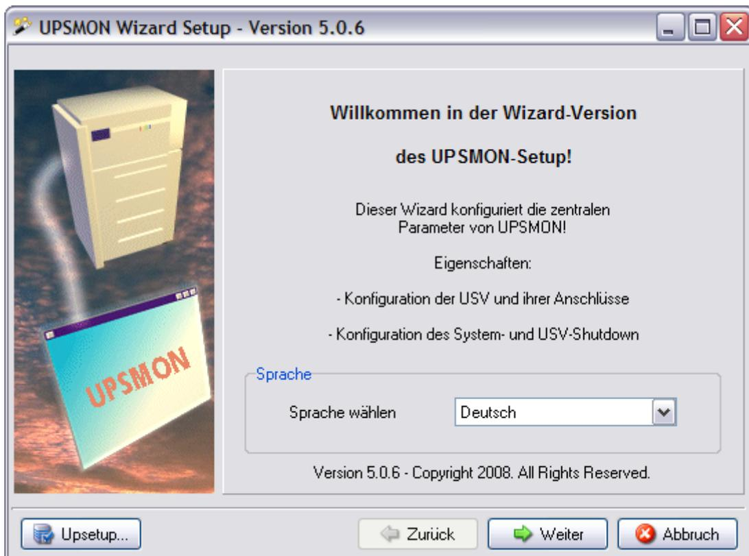
2. **USV-Konfigurationsseite:** Auf dieser Seite können die USV-Parameter und die für die Kommunikation mit der USV zu verwendenden Verbindungsparameter konfiguriert werden.
