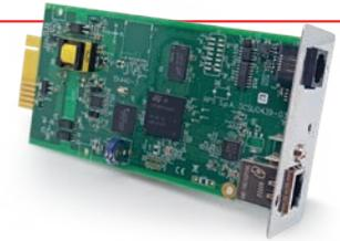
in tempo reale delle macchine virtuali (VM) verso dispositivi protetti da UPS in caso di disturbi elettrici, utilizzando sistemi di migrazione come VMware e vMotion™. NetMan 208 può monitorare e gestire l'UPS all'interno o all'esterno del data center. È inoltre in grado di misurare il consumo elettrico per calcolare l'efficacia di utilizzo della potenza (PUE), il parametro standard di valutazione dell'efficienza energetica dei data center.
