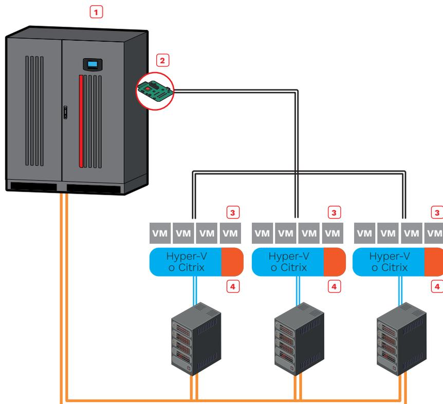
È necessario utilizzare il software PowerShield<sup>3</sup> per la gestione della configurazione con l'UPS e uno script specifico per arrestare il sistema virtualizzato, l'UPS deve avere la scheda NetMan 208 installata.
