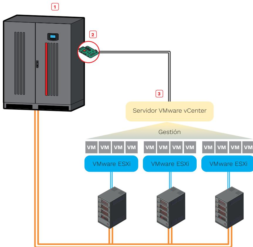
El NetMan 208 se debe usar para manejar los hosts Esxi y los servidores vCenter, para poder gestionar la red virtual y realizar apagados o migraciones en vivo de máquinas virtuales activas así como apagados de hosts físicos con retrasos y prioridades programados.
