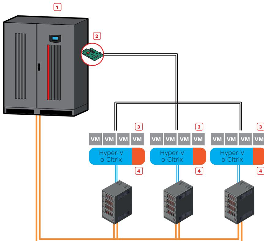
El software Powershield<sup>3</sup> debe usarse para manejar la configuración con el SAI; se debe usar un script específico para apagar el sistema virtualizado, y el SAI debe tener una tarjeta NetMan 208 instalada.
