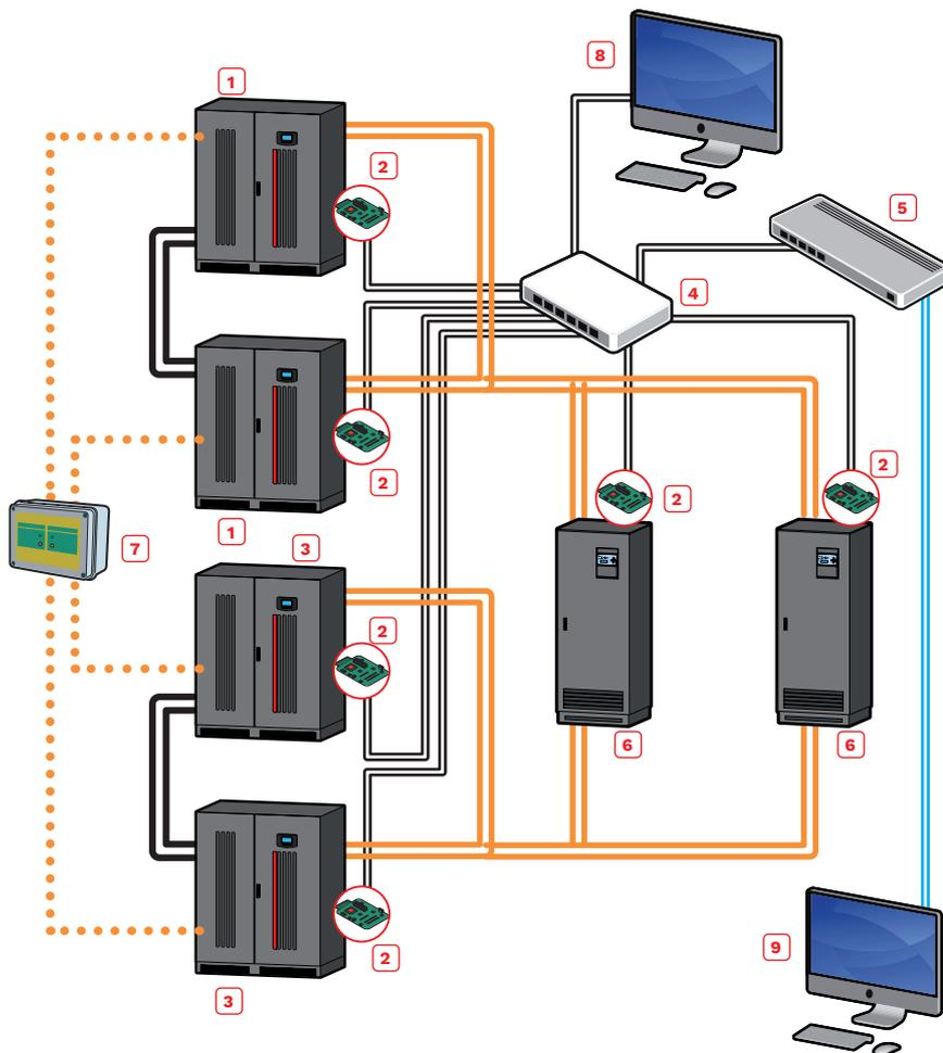
La versión COMPLETA del software PowerShield<sup>3</sup> se debe usar para manejar las configuraciones de varios SAI instalados en paralelo y cada SAI debe tener una tarjeta NetMan 208 instalada.
