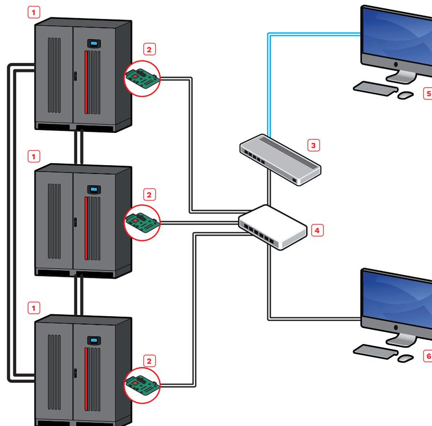
La versión COMPLETA del software PowerShield<sup>3</sup> se debe usar para manejar las configuraciones de varios SAI instalados en paralelo y cada SAI debe tener una tarjeta NetMan 208 instalada.
